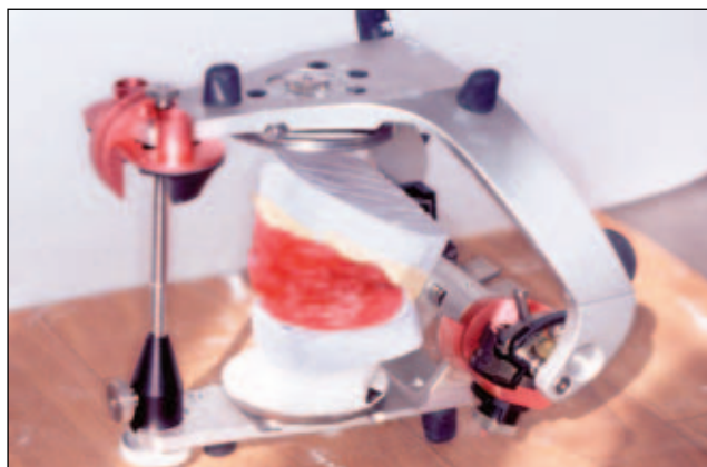
Obr. 18 Montážní stůl je nahrazen sloupkem a individuálním stolcem řezákového vedení a opěrkou, k hornímu modelu je připojena dolní šablona a dolní model.
